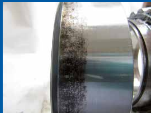
Ovalverformung – Radnabe nicht in Ordnung
